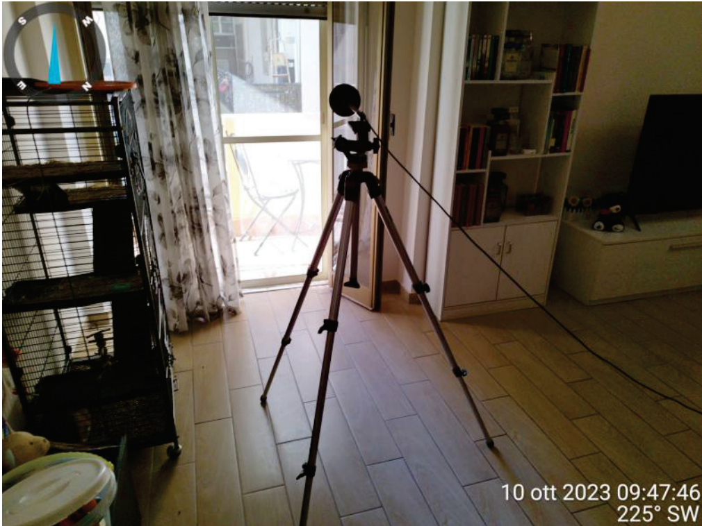
Foto2 – Posizione di misura 1 all'interno dell'abitazione del ricettore
